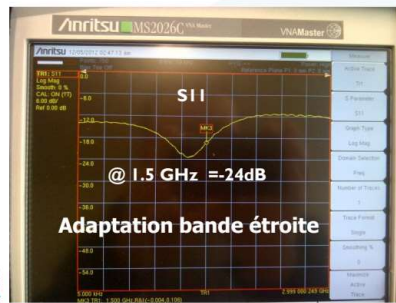
Exemple d'une mesure d'une adaptation d'une charge 75 Ohm
